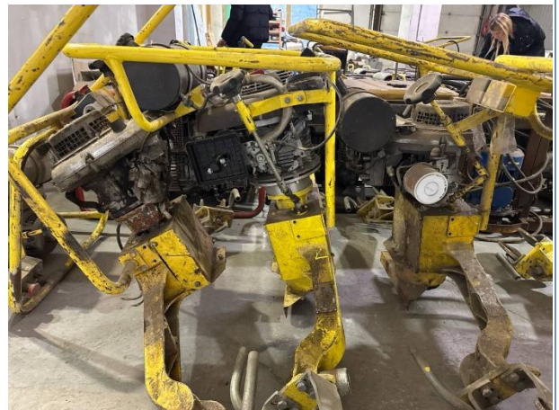
Станок шлифовальный MR-150 копирующий с выходом момента
