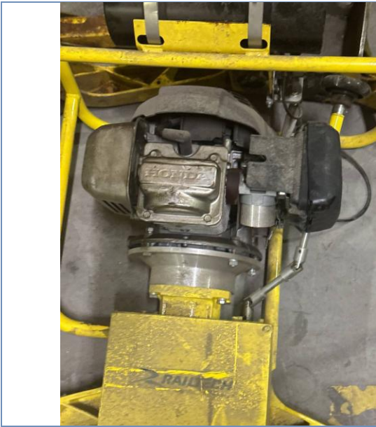
Станок шлифовальный MR-150 копирующий с выходом момента
