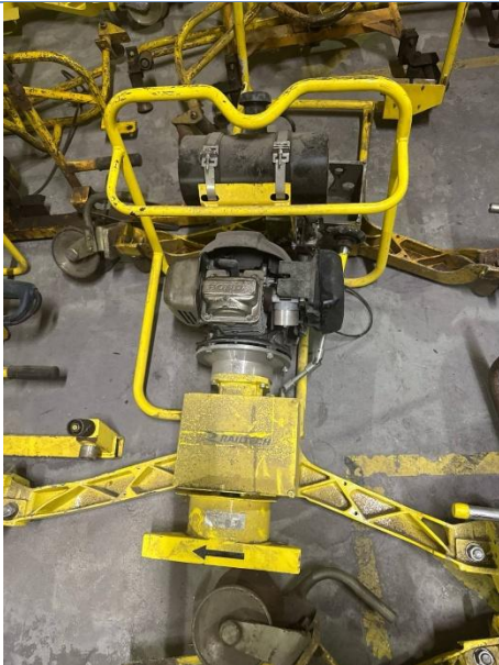
Станок шлифовальный MR-150 копирующий с выходом момента
